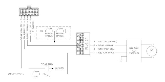
FUEL SYSTEM WIRING (USING VARIABLE SPEED PUMP CONTROLLER)
